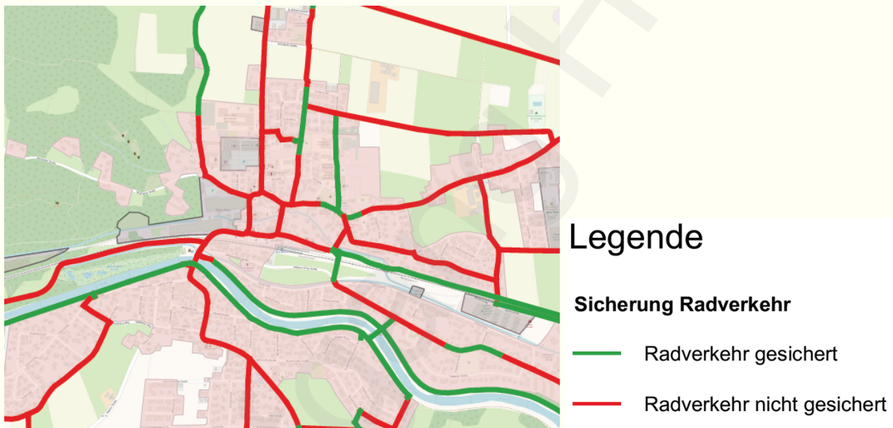
Abbildung 14: Netzkarte mit Hervorhebung der Netzlücken/ungesicherter Abschnitte (rot)
